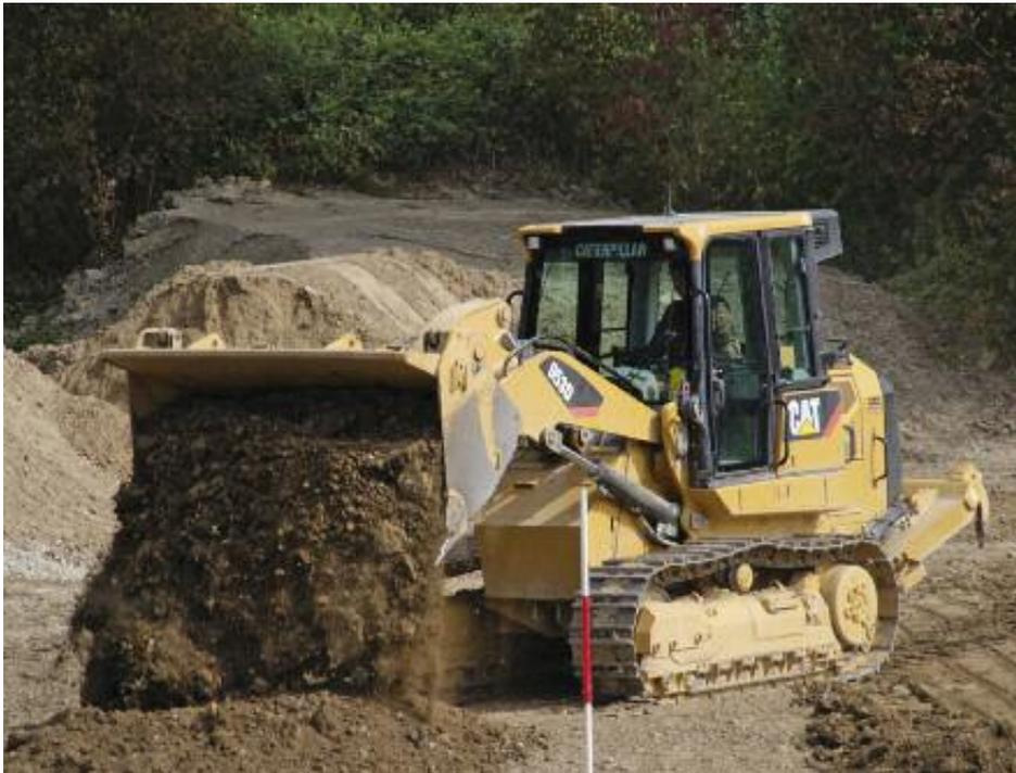
Die Laderaube CAT 953 wird bei den Spezialpionieren eingesetzt. Sie dient zum Ausheben von Tankbetten, Abtragen von Erdwänden, Räumen von natürlichen und künstlichen Hindernissen sowie zum Beladen von Transportfahrzeugen.
