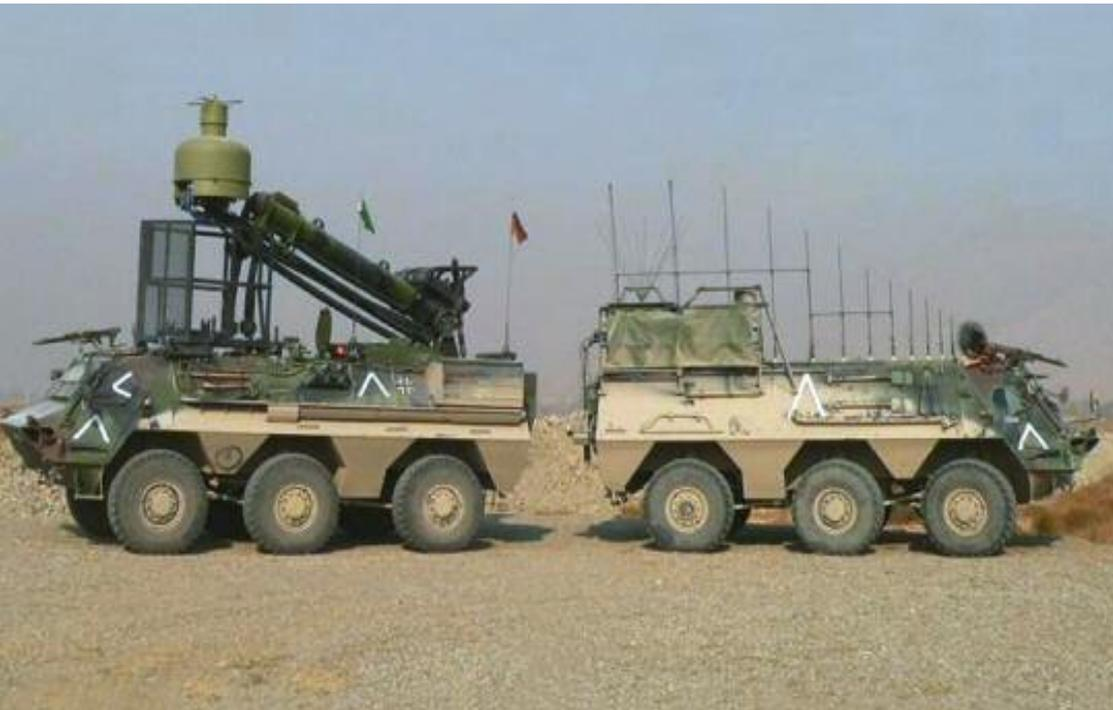
Die Fahrzeuge werden im Einsatz unmittelbar zur Unterstützung der eigenen Kräfte eingesetzt. Dabei kann der gesamte Bereich des relevanten elektromagnetischen Spektrums abgedeckt werden. Der Radarpeiler RMB dient der Erfassung, Peilung und Auswertung von modernen Radarsignalen.
