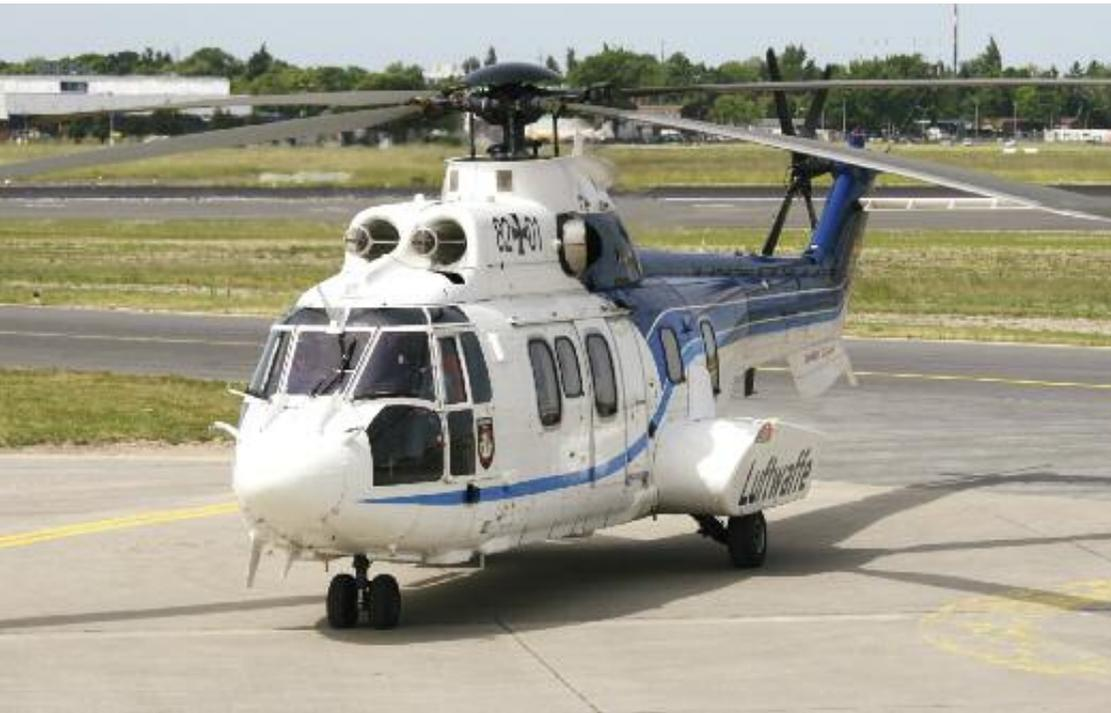
Der COUGAR AS532 ist ein von Eurocopter gebauter Mehrzweckhubschrauber mittlerer Größe, der bei der Luftwaffe für den VIP-Personentransport eingesetzt wird.
