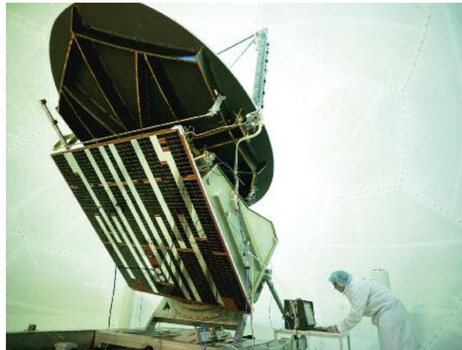
Das System besteht aus fünf Satelliten auf drei Orbits in circa 500 Kilometern Höhe, die weltweit wetter- und tageslicht-unabhängig Radarbilder gewinnen können. In einer Bodenstation werden diese Bilder durch fachkundiges Personal ausgewertet und den Bedarfsträgern als Lageinformation zur Verfügung gestellt. Über einen Systemverbund mit Frankreich wird der Zugang zu Satellitenbildern des optischen System Helios II sichergestellt.
