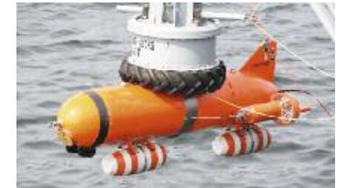
Die Minenjagddrohne PINGUIN B3 identifiziert Kontakte mittels Videokamera und hochauflösendem Nahbereichssonar.
