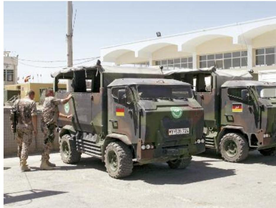
Das allradgetriebene, geschützte Radfahrzeug der spezialisierten Kräfte ist mit gepanzertem Fahrerhaus und gepanzertem Rundumverglasung ausgestattet. Der MUNGO ist luftverladbar im Mittleren Transporthubschrauber vom Typ CH-53G.
