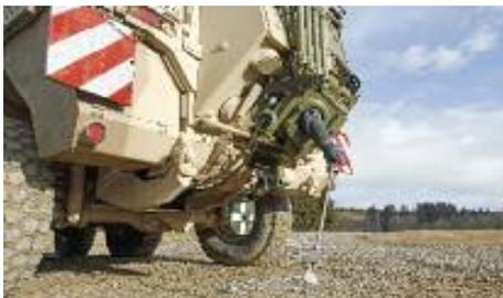
Der Spürpanzer FUCHS dient der Durchführung der mobilen, großräumigen und geschützten A-/C-Einsatzaufklärung. Trägerfahrzeug ist der Transportpanzer FUCHS in der Variante TPz 1 A8A7 ABC.
