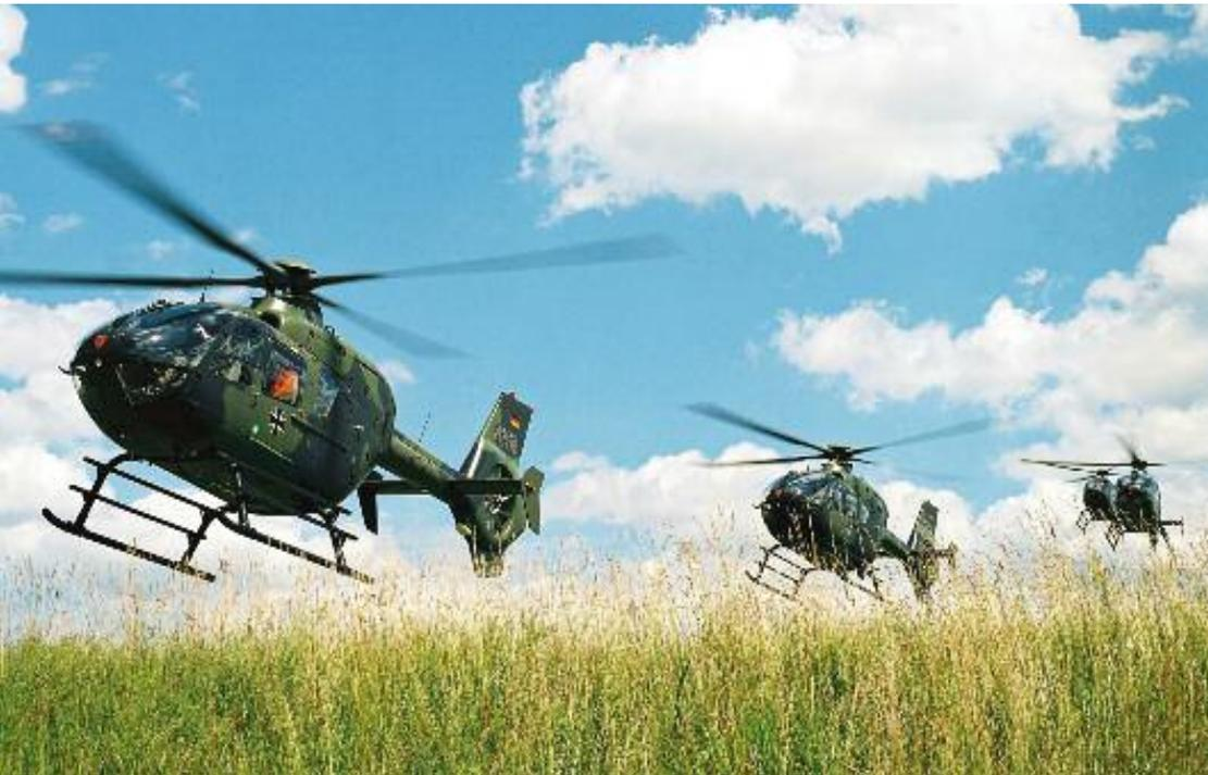
Der neue Schulungshubschrauber (SHS) vom Typ EC 135 verfügt über zwei Triebwerke, ein digitales Cockpit, Autopilot und ein Flug-Management-System. Flugschüler lernen innerhalb von zwölf Monaten nicht nur die Beherrschung des SHS nach Sichtflugregeln, sondern erhalten auch die Qualifikation für den Instrumentenflug und den Sensorflug im Nachttiefflug.
