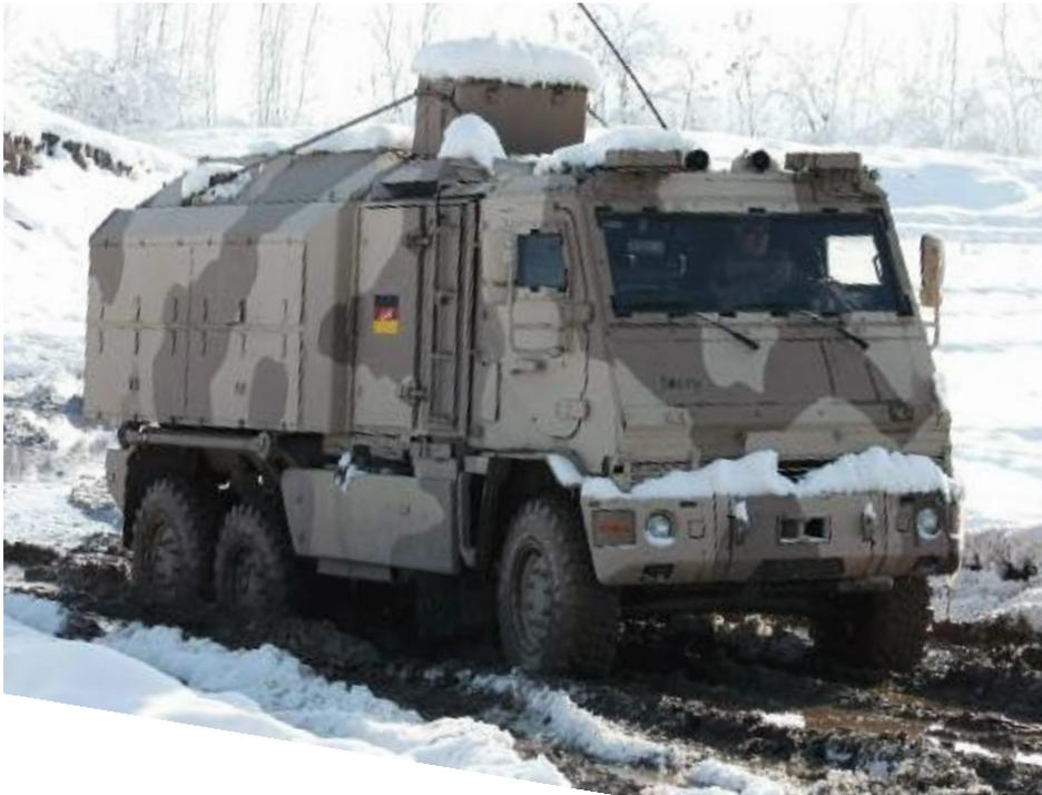
Der DURO 3 ist ein gepanzertes Transportfahrzeug. Die Panzerung des Fahrzeugs schützt die Besatzung vor Beschuss durch Infanteriewaffen und vor der Wirkung von Minen. Die DURO-Fahrzeuge haben die im Auslandseinsatz befindlichen ungepanzerten Trägerfahrzeuge abgelöst.
