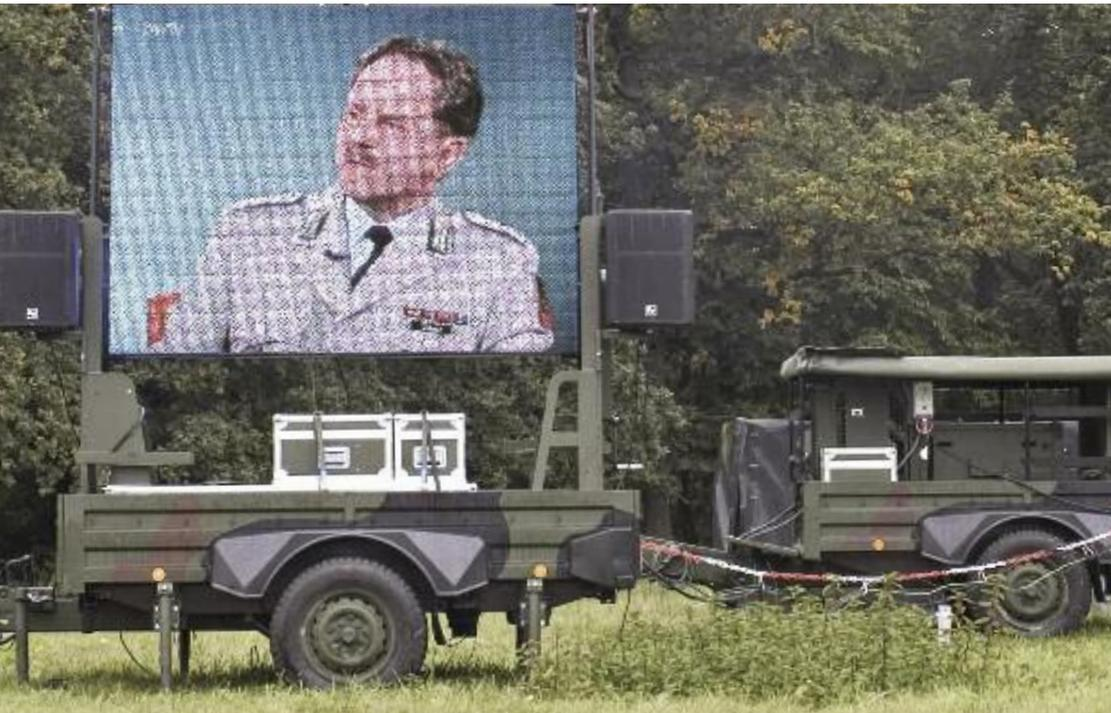
Die Videowiedergabeausstattung ist auf zwei Einachsanhängern verlastet. Ein Anhänger trägt die Zuspielelemente und das Stromerzeugeraggregat und ein zweiter die LED-Wand mit einer Bildschirmdiagonalen von drei Metern.
