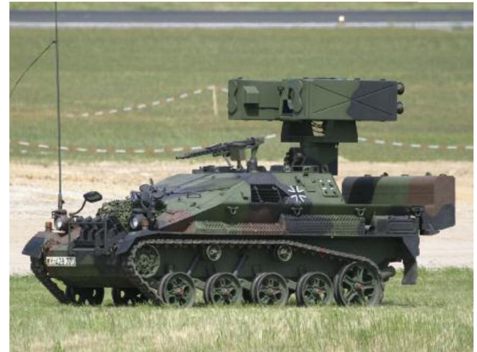
Zur Ergänzung der vorhandenen Waffen/Waffensysteme zur Flugabwehr hat die Luftwaffe ein mobiles und leichtes Flugabwehrsystem erhalten (LeFlaSys). Dieses soll insbesondere zum Schutz leichter und luftbeweglicher Truppen dienen. Bei dem Fahrzeug handelt es sich um eine verlängerte und modifizierte Version des WIESEL. Der Flugabwehrraketenträger OZELOT wird im Verbund eingesetzt und bekämpft die aufgeklärten feindlichen Luftfahrzeuge mit Flugabwehrraketen STINGER.
