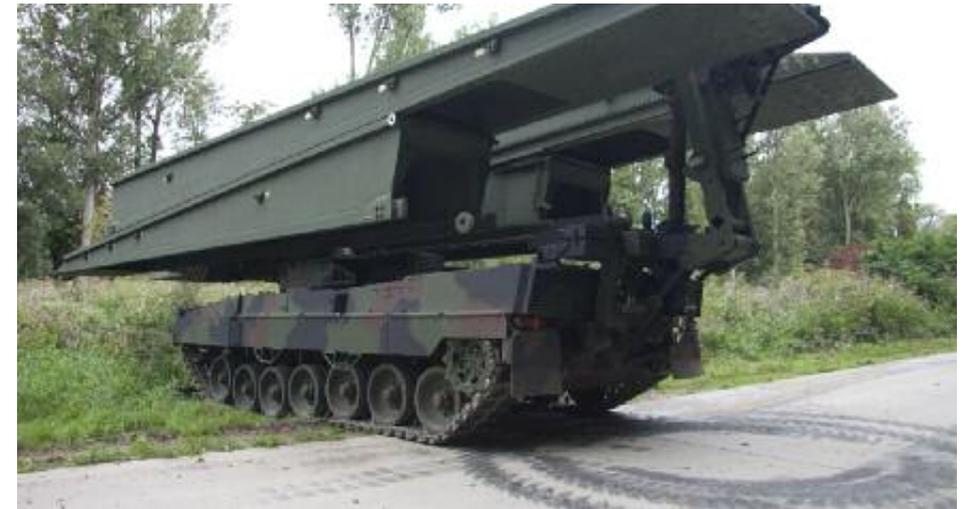
Das gepanzerte Brückenlegesystem (GFB – GEPBRLSYS) ist die konsequente Weiterentwicklung des Verlegeprinzips der Panzerschnellbrücke BIBER. Das System GFB – GEPBRLSYS, dessen Brücken problemlos mit Fahrzeugen der Klasse MLC80 passiert werden können, bietet nicht nur ausreichend Kapazität für die in der Bundeswehr eingeführten Systeme (Limit derzeit MLC70). Auch zukünftige Systeme oder überschweres Großgerät verbündeter Streitkräfte ist es in der Lage zu tragen.
