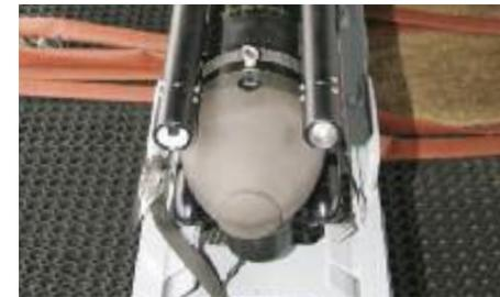
Der SEEFUCHS fährt weitgehend automatisch zur Mine. Mit einem Nahbereichssonar und einer Videokamera wird das Zielobjekt identifiziert.
