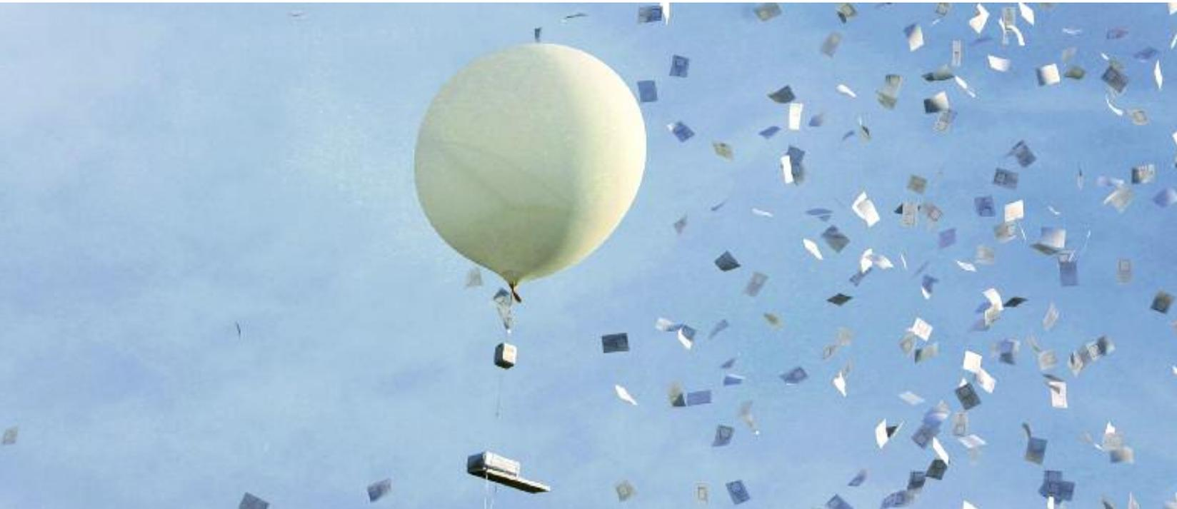
Abstandsfähig und über weite Distanz können Produkte (zum Beispiel Flugblätter) mittels Ballon in schwerzugängliche oder gefährliche Regionen verbracht werden. Die Ballone können Lasten von bis zu vier Kilogramm etwa 30 Kilometer weit tragen.
