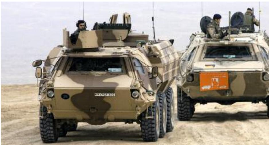
Der Transportpanzer FUCHS ist ein geländegängiges, gepanzertes Radfahrzeug (6 x 6), das ursprünglich als reines Transportfahrzeug konzipiert wurde. Heute wird er mit verschiedenen Rüstsatzvariationen bei zahlreichen Truppengattungen eingesetzt. Beispiele hierfür sind die Variante ABC-Spürpanzer bei der ABC-Truppe, der Einsatz als Personentransportfahrzeug bei der Jägertruppe oder als vorgeschobene Befehlsstelle für Gefechtsstände.
