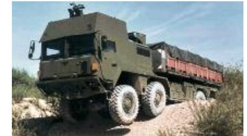
Das Transportsystem MULTI (Mechanisierte Umschlag-, Lager- und Transportintegration) mit Fahrzeugschutzausstattung ist für den Transport von Versorgungsgütern in schwerem Gelände vorgesehen. Der MULTI stellt den Transport und zeitsparenden Umschlag im Einsatz sicher und ist das wesentliche Transportsystem der mobilen Logistiktruppen der Streitkräftebasis.
