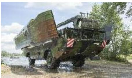
Die Amphibie M3 wird beim Überqueren von Gewässern als Schwimmbrücke oder als Mehrfachfähre eingesetzt. Eine 100 Meter lange Schwimmbrücke kann mit acht M3 in weniger als 20 Minuten gebaut werden. Die Fahrbahnbreite beträgt 4,76 m.
