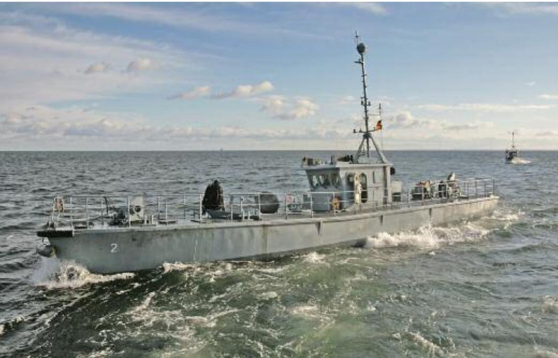
Die SEEHUNDE sind kompakte Minenräumeinrichtungen, die gegen Minen mit akustischen und magnetischen Zündsystemen eingesetzt werden. Sie können Detonationen von Minen selbst in geringer Entfernung gefahrlos überstehen.
