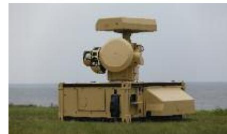
Das Modular, Automatic and Network capable Targeting and Interception System (kurz: MANTIS) ist ein Nächstbereich-Schutzsystem, mit dem die Luftwaffe den Einstieg in eine neue Generation von Schutzsystemen gegen Raketen-, Artillerie- und Mörserangriffe vollzogen hat. Das System dient vorrangig zum Schutz von Einrichtungen und Objekten, insbesondere von Feldlagern gegen jede Art von Bedrohungen aus der Luft.
