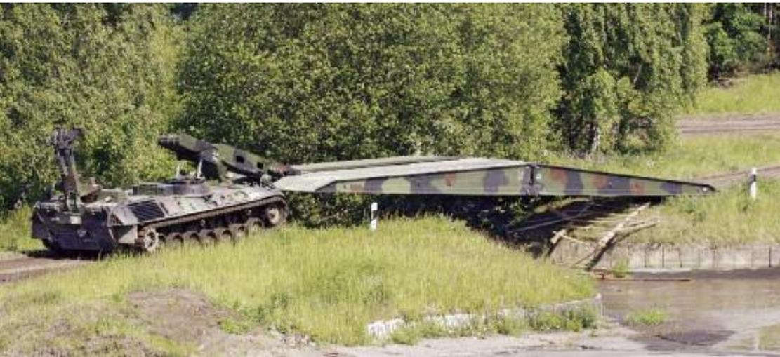
Mit dem System Panzerschnellbrücke BIBER unterstützt die Pioniertruppe die Beweglichkeit der eigenen Truppe. Mit der Brücke lassen sich Geländeeinschnitte, Schluchten oder Gewässer bis zu einer Breite von bis zu 20 Metern überwinden. Transport- und Verlegefahrzeug für die zwei je 11 Meter langen Brückenelemente ist ein LEOPARD 1 Fahrgestell.
