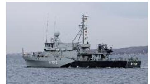
Die Boote der ENSDORF-Klasse sind mit einem Minenmeidesonar zum Lokalisieren von Ankertauminen, mit einer Lenk- und Überwachungseinrichtung für die vier Fernlenkräumgeräte, Einwegdrohnen SEEFUCHS sowie mechanischem Räumgerät gegen Ankertauminen ausgestattet.
