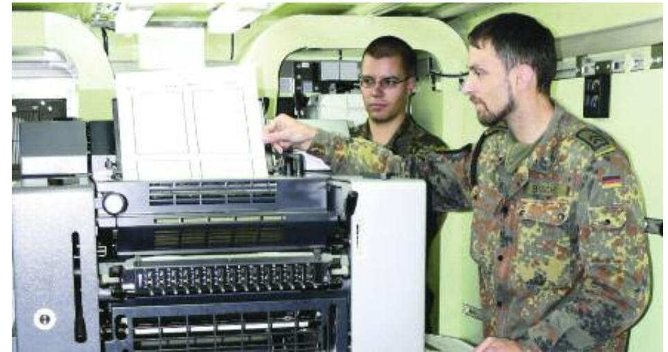
Die kleinformatige Offsetdruckpresse (bis DIN A3) ist das aktuelle Vervielfältigungssystem im mobilen Druck. Sie ist in einer klimatisierten Kabine II FM A montiert und bedruckt Papier mit zwei Farben in einem Druckgang. Papier mit einem Gewicht von 40 bis 300 Gramm pro Quadratmeter kann hier eingesetzt werden. Stündlich können bis zu 6.000 Blatt gedruckt werden.
