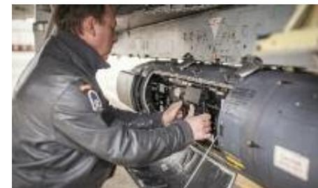
Mit den Infrarot- und optischen Sensoren kann bei Tag und Nacht hochauflösendes digitales Bildmaterial aus niedrigen und mittleren Höhen gesammelt werden.
