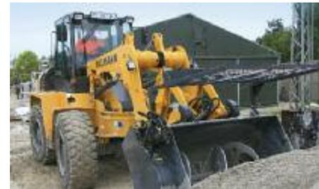
Der Schwenklader gehört zu den individuellsten Baumaschinen der Spezialpioniere. Seine enorme Vielseitigkeit (Kipplader, Bagger, Stapler, Planiergerät, Zugmaschine, Kran) und sein geringer Wenderadius von 4,35 m ermöglichen, mit seiner umfangreichen Ausstattung, vielseitige Einsatzmöglichkeiten.
