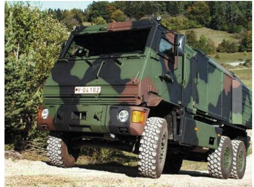
Das Haupteinsatzfahrzeug für die Kampfmittelbeseitigung wird zukünftig das geschützte Führungs- und Funktionsfahrzeug vom Typ DURO sein. Dieses Fahrzeug verfügt über einen Schutz gegen Minen sowie über ballistischen und Splitterschutz, kann unter ABC-Bedingungen eingesetzt werden und besitzt eine autarke Energieversorgung.
