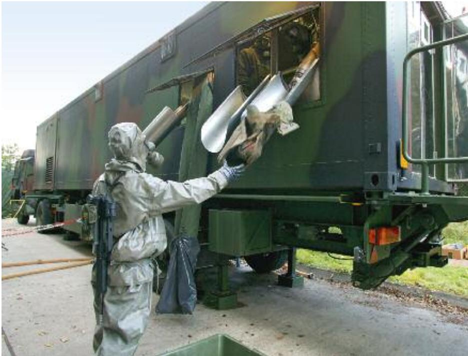
Der HEP 90 Pers dient primär der Entfernung von strahlenden Restpartikeln und Schmutz von der Haut. Die hygienischen Maßnahmen (Duschen) und ggf. die Dekontamination erfolgen durch die Verwendung von Wasser und Flüssigseife.
