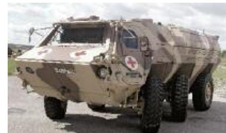
Für den Einsatz in Krisengebieten wurde der Transportpanzer FUCHS als Sanitätsvariante zusätzlich mit spezifischen Schutzvorrichtungen ausgestattet. Dazu gehören unter anderem zusätzlicher Minenschutz sowie Schutz gegen die Blastwirkung von Improvised Explosive Devices (IED).
