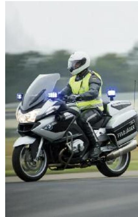
Die Ausstattung umfasst unter anderem eine elektronisch verstellbare Windschutzscheibe, ABS, ein Funkgerät sowie drei Blaulichter und zwei Einsatzhörner. Zusätzlich sind zwei Koffer für den Transport von Ausrüstung angebracht.
