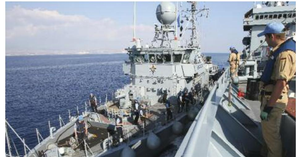
Die Hohlstaplenboote der ENSDORF-Klasse bilden mit den Fernräumlenkgeräten vom Typ SEEHUND das System TROIKA PLUS. Das Einsatzverfahren sieht vor, dass bis zu vier unbemannte SEEHUNDE mit aktivierten Minenräumanlagen vom Lenkfahrzeug aus ferngesteuert werden. Das Lenkfahrzeug selbst liegt dabei aus Sicherheitsgründen außerhalb des Minenfelds.
