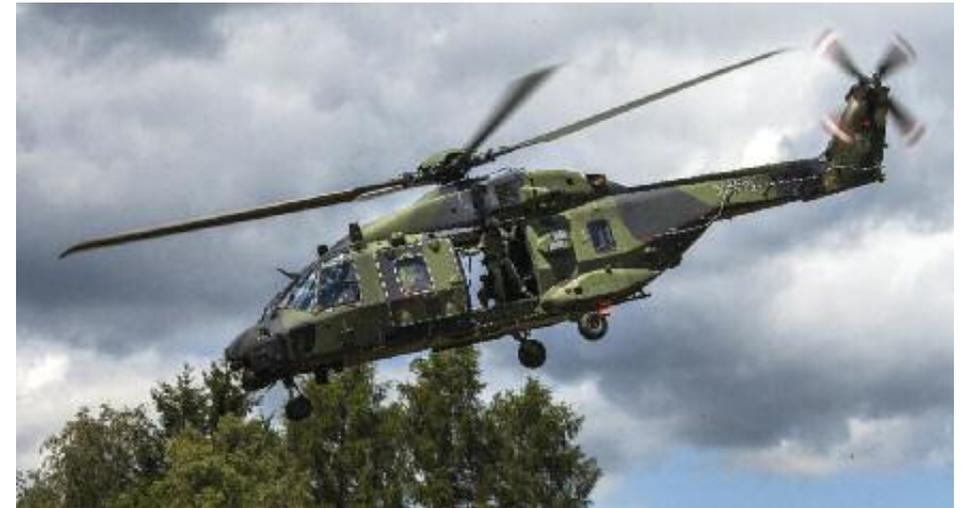
Der Mehrzweckhubschrauber NH90 wurde im Auftrag von Frankreich, Italien, den Niederlanden und Deutschland entwickelt. Er ist ein Hubschrauber der Zehn-Tonnen-Klasse, der ausgehend von einem Basismuster ein Familienkonzept beinhaltet. Mit dem NH90 können sowohl schwere Lasten, technisches Material als auch bis zu 20 Soldaten transportiert werden.
