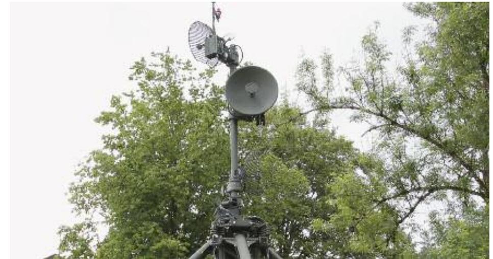
Mit dem moderneren Richtfunksystem TERRESTRISCHES ÜBERTRAGUNGS-SYSTEM KURZE REICHWEITE (TÜtrSys) werden, im Kommunikationssystem der Bundeswehr richtfunkbasierte Verbindungen zwischen Netzknoten hergestellt sowie führungswichtige Einrichtungen angebunden.
