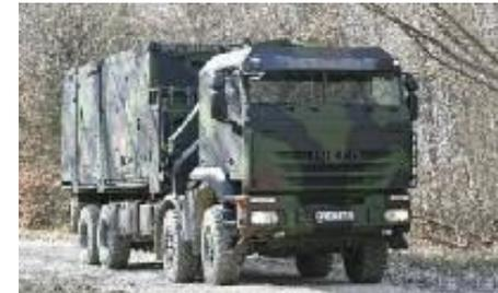
Die Dekontaminationsausstattung Materialentstrahlungs-, -entgiftungs- und -entseuchungsplatz (MEP vlb) dient der Vor- und Nachbehandlung bei der gründlichen Dekontamination in einer Dekontaminations-einrichtung im Zusammenwirken mit der Dekontaminationsausstattung TEP 90.
