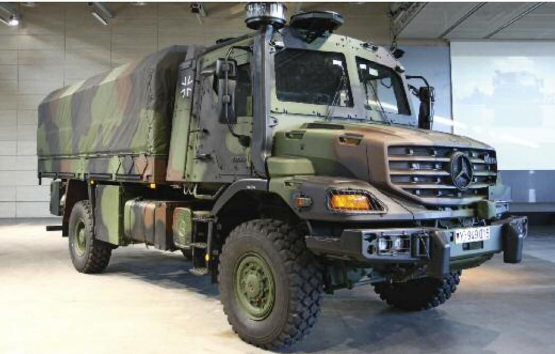
Der ZETROS 5 t verfügt im Vergleich zu den bisher von der Bundeswehr im Einsatz genutzten Transportfahrzeugen gleicher Tonnage über einen erheblich gesteigerten Schutz im Bereich der Ballistik sowie gegen Minen und Sprengfallen. Durch eine ABC-Schutzbelüftungsanlage und die Möglichkeit zur Aufnahme einer fernbedienbaren Waffenstation wird der Schutz des Fahrzeuges und damit der Soldatinnen und Soldaten weiter erhöht.
