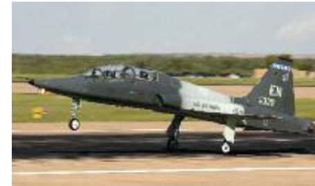
Die T-38 ist ein zweistrahliger Überschall-Trainer. Die Maschinen werden im Rahmen der Jet-Ausbildung zur Einweisung in taktische Verfahren im Anschluss an die Grund- und Fortgeschrittenenausbildung auf der Air Force Base im texanischen Sheppard eingesetzt.
