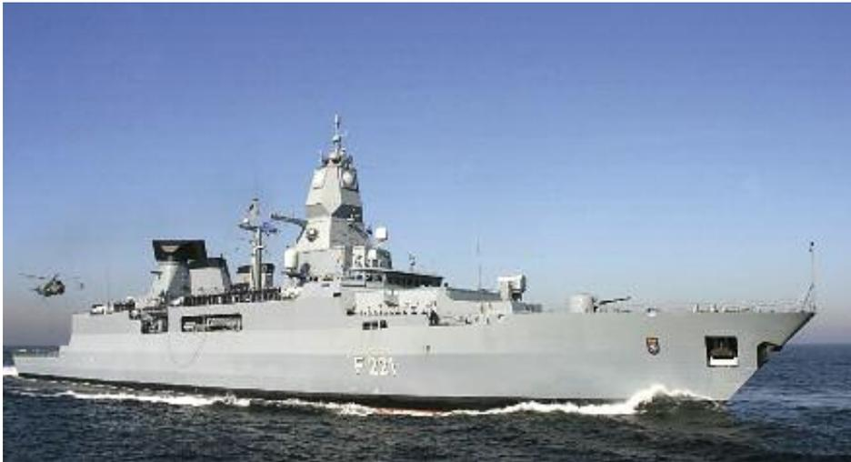
Die Fregatten der SACHSEN-Klasse sind als Mehrzweckfregatten für Geleitschutz und Gebietssicherung konzipiert und verfügen über Bordhubschrauber. Sensoren und Effektoren sind auf ihre Hauptaufgaben optimiert: Verbandsführung und Verbandsflugabwehr. Wie bei den Fregatten der BREMEN- und BRANDENBURG-Klasse dient der Bordhubschrauber der weitreichenden Seezielbekämpfung und Ubootjagd.
