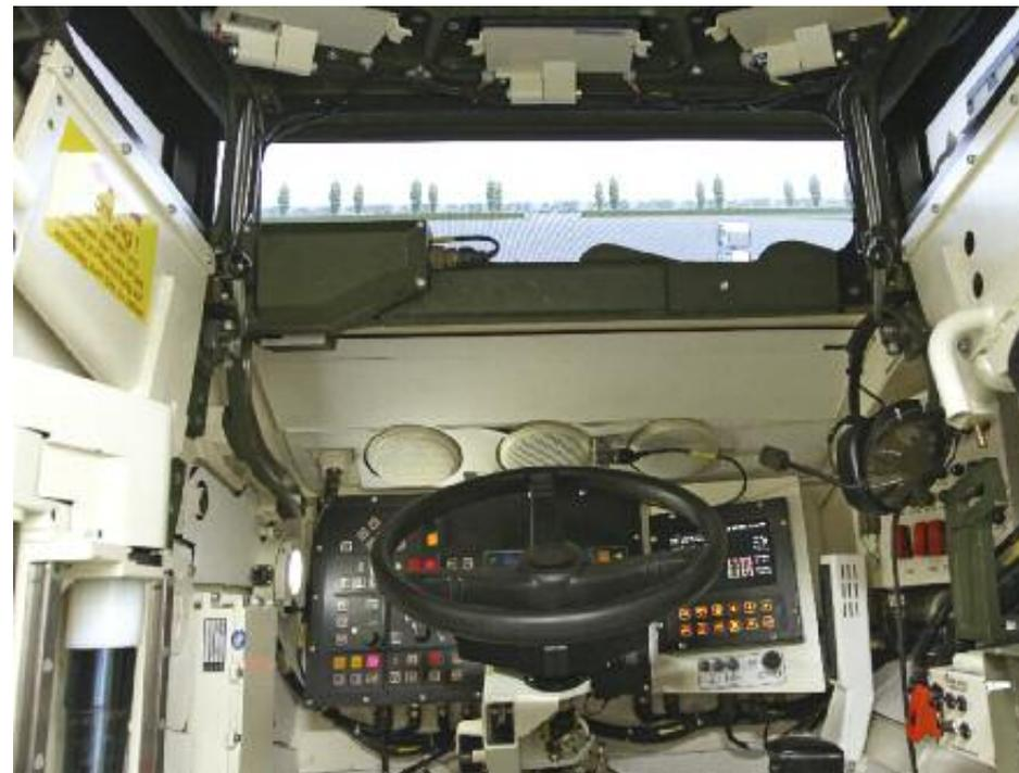
Die Simulatorkabine ist eine originalgetreue Nachbildung des Fahrerplatzes, bei der sämtliche Bedienelemente mit der entsprechenden Funktion hinterlegt und mit der entsprechenden Kraftfahrzeugnachbildung abgebildet hinterlegt sind. Über ein mehrkanaliges PC-Sichtsystem werden die Sichtverhältnisse des Realfahrzeugs originalgetreu abgebildet.
