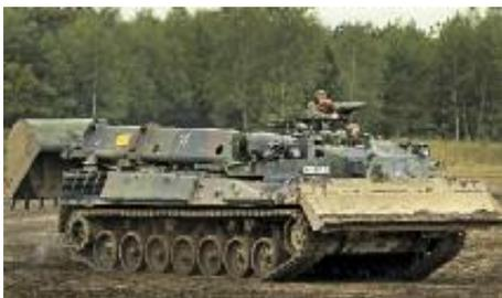
Der Pionierpanzer DACHS wurde auf der Basis des Kampfpanzers LEOPARD 1 entwickelt. Er wird in den Panzerpionierkompanien und Pionierbataillonen eingesetzt. Mit dem DACHS können unter anderem größere Erdbewegungen realisiert werden.
