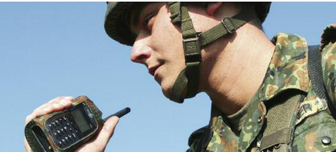
TETRAPOL Bw ist ein Kommunikationsmittel für mobile Kräfte und stellt ein digitales Übertragungsmittel für verschlüsselte Sprach- und Datenübermittlung dar, das in den Internetprotokoll-basierten Kommunikationsverbund integriert werden kann. Es integriert Teilnehmer in den Verbund der bestehenden Kommunikationsnetze, um eine gesicherte Truppenführung und gezielte Führung einzelner Teilnehmer zu ermöglichen.
