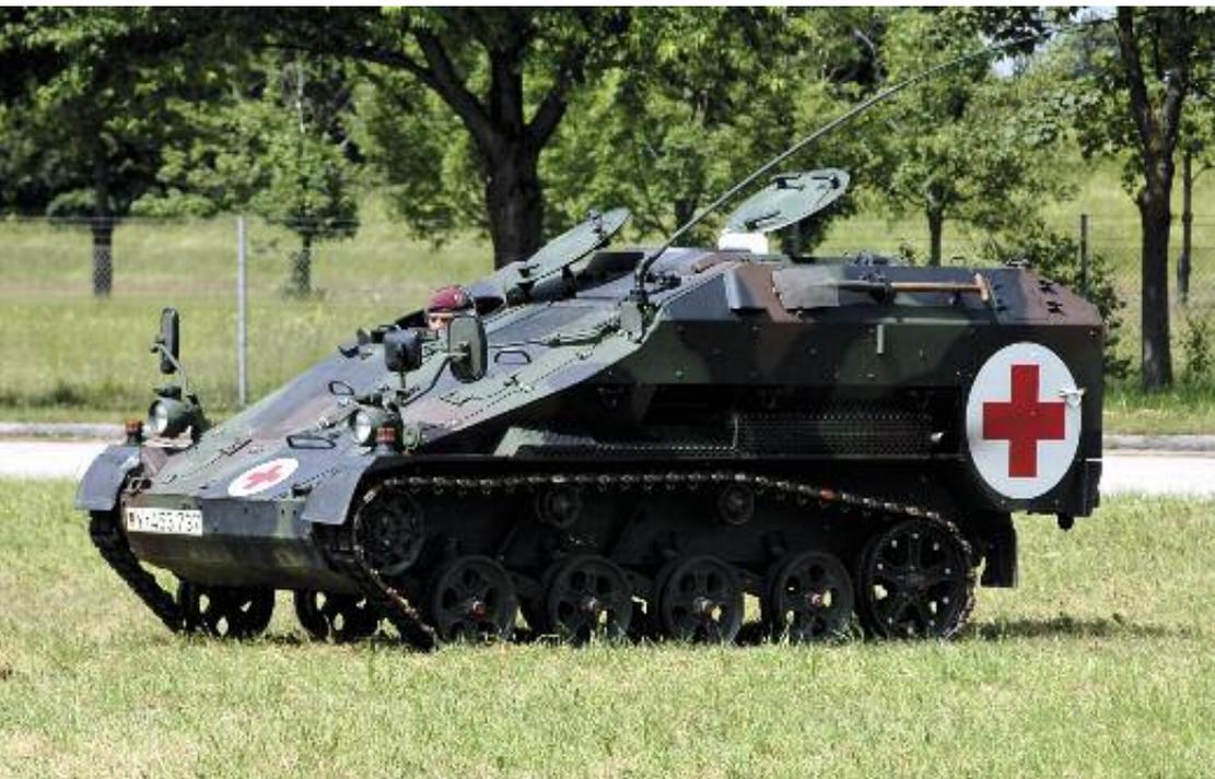
Beim WIESEL 2 handelt es sich um ein leicht gepanzertes Führungs- und Transportfahrzeug. Der im Vergleich zum WIESEL 1 mit erhöhter Zuladekapazität und größerem Platzangebot ausgestattete WIESEL 2 kommt in verschiedenen Spezifikationen, unter anderem als Fahrzeug zum Patiententransport, zum Einsatz.
