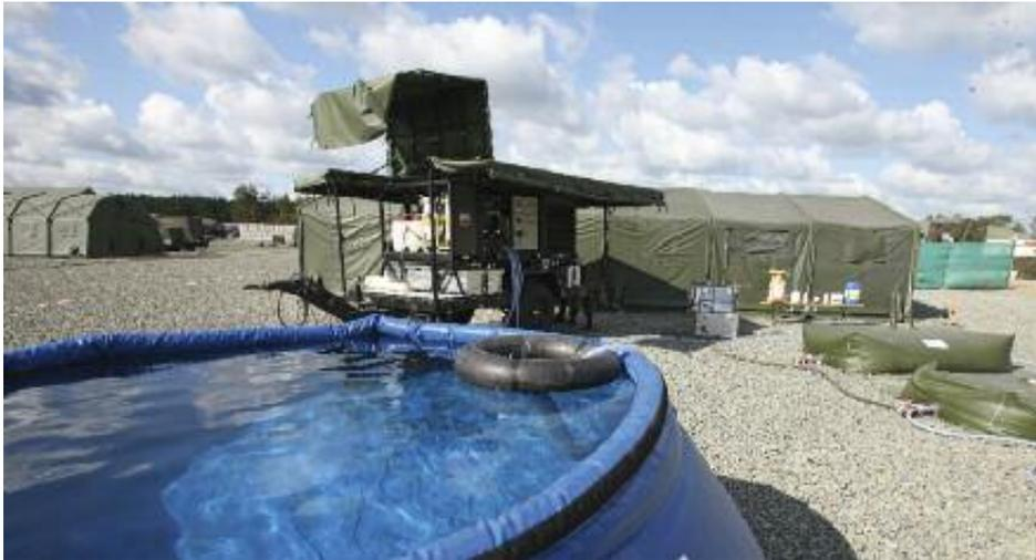
Mit der Wasseraufbereitungsanlage für Dekontaminationszwecke (WAA Dekon) wird Wasser zu Dekontaminationszwecken aufbereitet. Im Rahmen der beweglichen Unterbringung erfolgt die Aufbereitung des Wassers nach der Trinkwasserverordnung für den persönlichen Bedarf.
