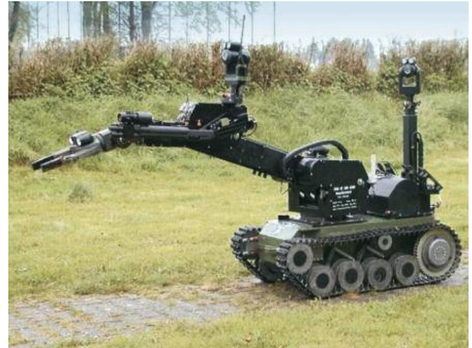
Die Nutzung ferngesteuerter Manipulatoren erhöht den Schutz und die Sicherheit der Kampfmittelbeseitigungskräfte im Einsatz in erheblichem Maße. Das wichtigste Einsatzmittel ist das Manipulatorfahrzeug tEODdor.
