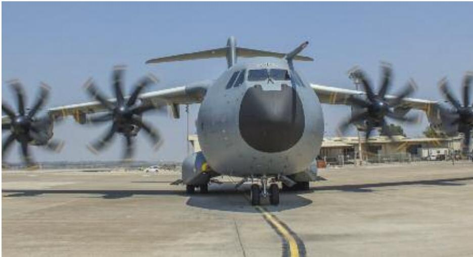
Der AIRBUS A400M wurde im Dezember 2014 in die Luftwaffe eingeführt und wird die TRANSALL ersetzen. Der Schulterdecker besitzt vier Propeller-Motoren und wurde als strategisches und taktisches Transport- und Tankflugzeug konzipiert. So kann er zusätzlich zu seiner Verwendung als Transportflugzeug für Personal und Material durch Einrüstung entsprechender Rüstsätze auch als Tanker oder Patiententransporter (MedEvac) eingesetzt werden.
