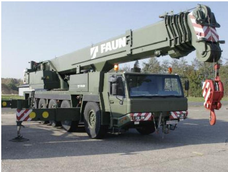
Der FAHRZEUGKRAN 120 T wird beim Auf- und Abbau von Feldlagern eingesetzt und kann, ohne seinen Standort wechseln zu müssen, Container mit einem Gewicht bis zu 24 t auch aus der zweiten oder dritten Reihe aufnehmen und absetzen.
